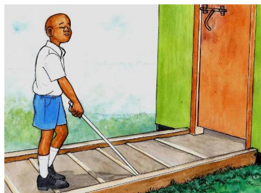
Slika 18: Toalet pristupačan za dete – sa karakterističnim taktilnim trakama na stazi i bezbednosnim ivičnjacima (Izvor: Government of Tanzania)
